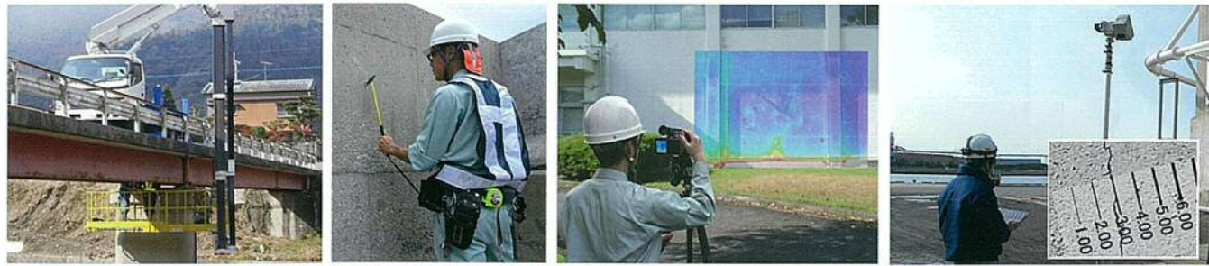
橋梁点検車による近接目視
