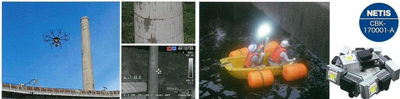
ドローン (UAV) によるデジタル画像取得
