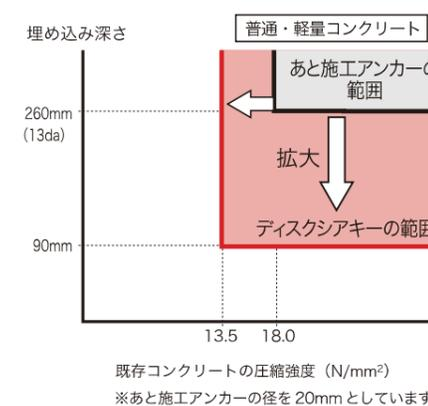
一般的な接着系のあと施工アンカーは、18.0N/mm<sup>2</sup>以下のコンクリート強度の建築物への適用が困難でした。ディスクシアキーによる外付け補強では13.5N/mm<sup>2</sup>から対応可能です。
