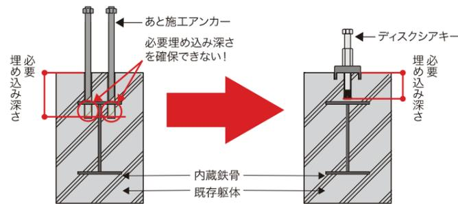
SRC造は鉄骨までのかぶり厚さが100mm程度のもが多く、在来工法(あと施工アンカー)の適用が困難な場合があります。ディスクシアキーは、コンクリート種別を問わず埋め込み深さは最短で60mm(標準:90mm以上)から適用できるため、SRC造の建築物の耐震補強に最適です。また、RC造建築物にも使用可能です。
