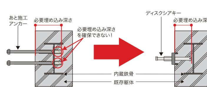
SRC造は鉄骨までのかぶり厚さが足りず、在来工法(あと施工アンカー)の適用が困難な場合があります。ディスクシアキーは、コンクリート種別を問わず埋め込み深さは最短で90mm(標準:140mm以上)から適用できるため、SRC造の建築物の耐震補強に最適です。また、RC造建築物にも使用可能です。
