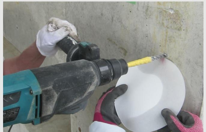
ドリル削孔粉を利用した中性化深さ測定
