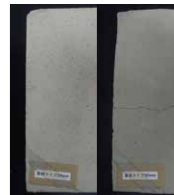
耐火試験後の外観
