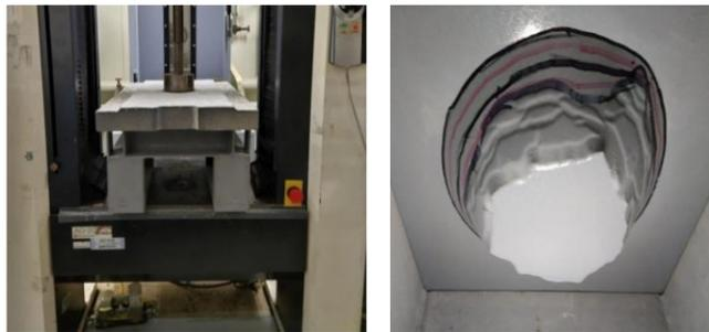
押抜き試験状況
