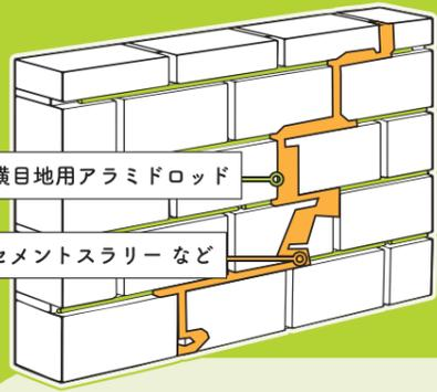
ひび割れ補修としても適用可能
