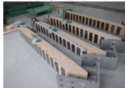
ブレース試験体写真（耐力壁タイプ）
