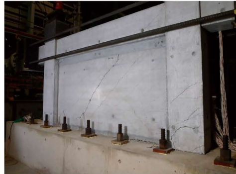
増設補強壁実験
